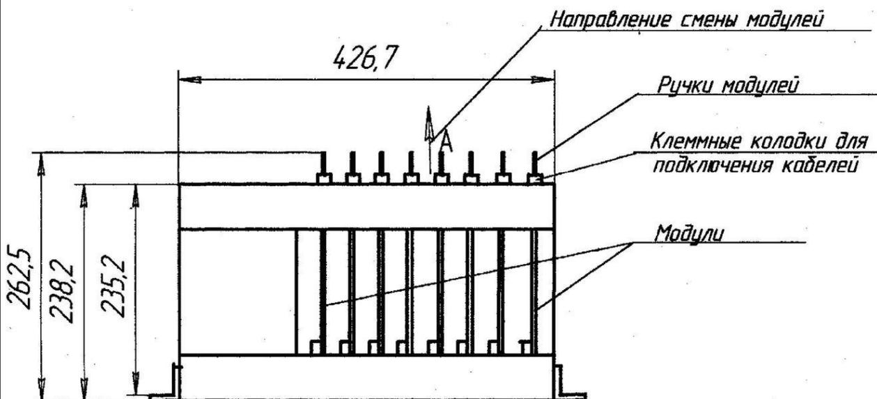
*Панель управления УПЭС выполнена в виде стандартного блока типа 3U19", предназначенного для установки в стойку.*
