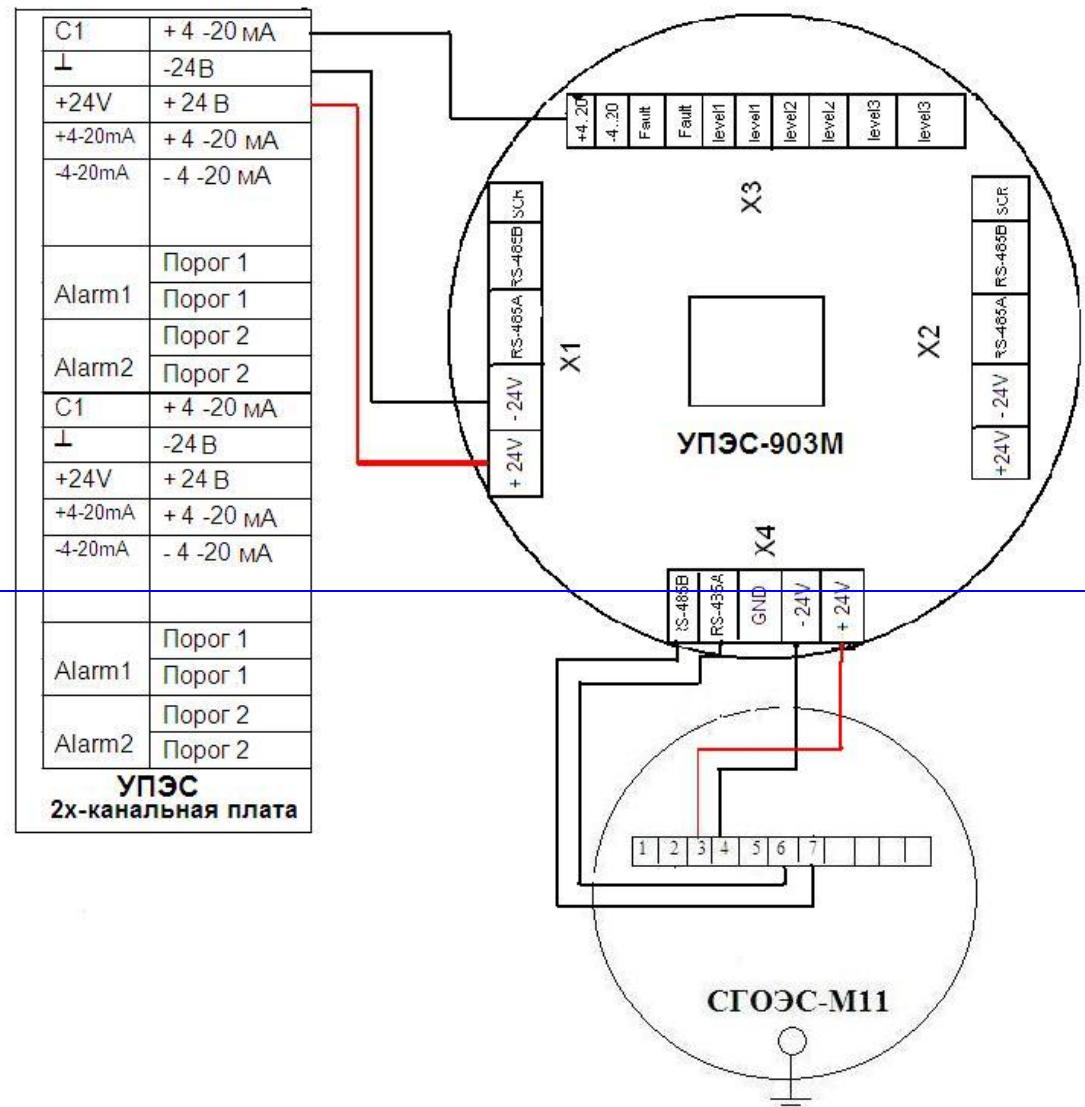
Рисунок 7 – Схема соединения СГОЭС-М11 с пороговым устройством УПЭС-903М с использованием цифрового выхода RS-485
