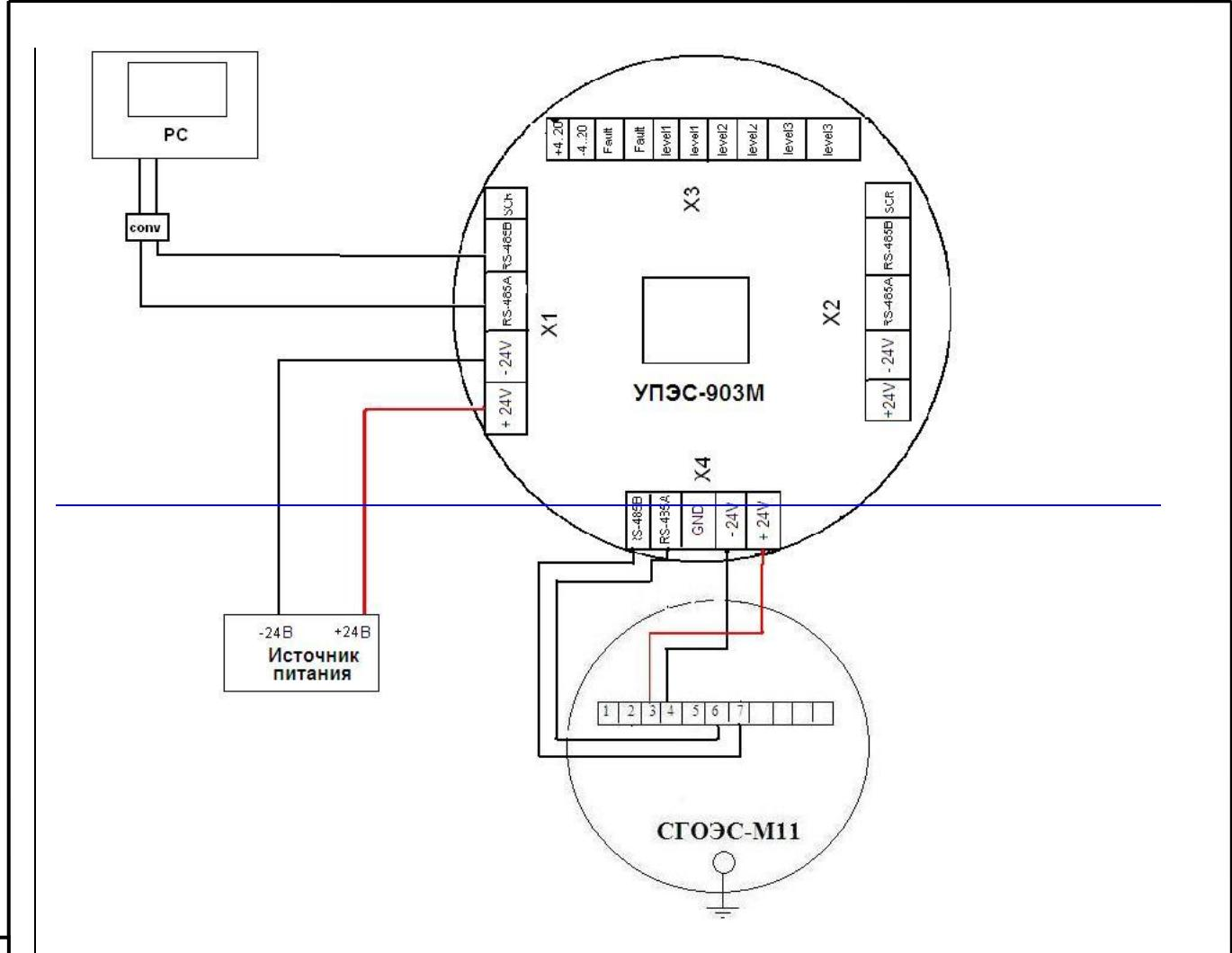
Рисунок 8— Схема использования СГОЭС-М11 в качестве удаленного сенсора, с использованием цифрового выхода RS-485
