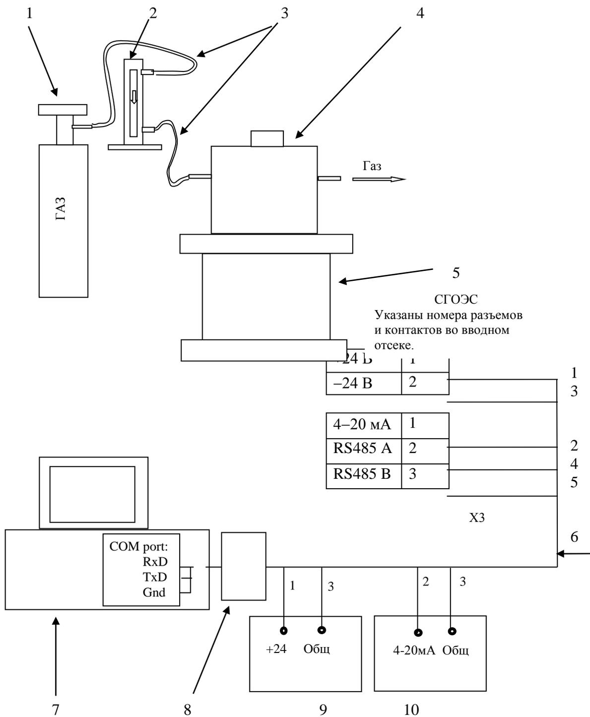
1 – баллон с поверочной газовой смесью; 2 – ротаметр; 3 – трубки для подачи газа; 4 – камера калибровочная; 5 – СГОЭС; 6 – кабель технологический; 7 – персональный компьютер; 8 – конвертор RS232↔RS485; 9 – источник питания; 10 – миллиамперметр.
