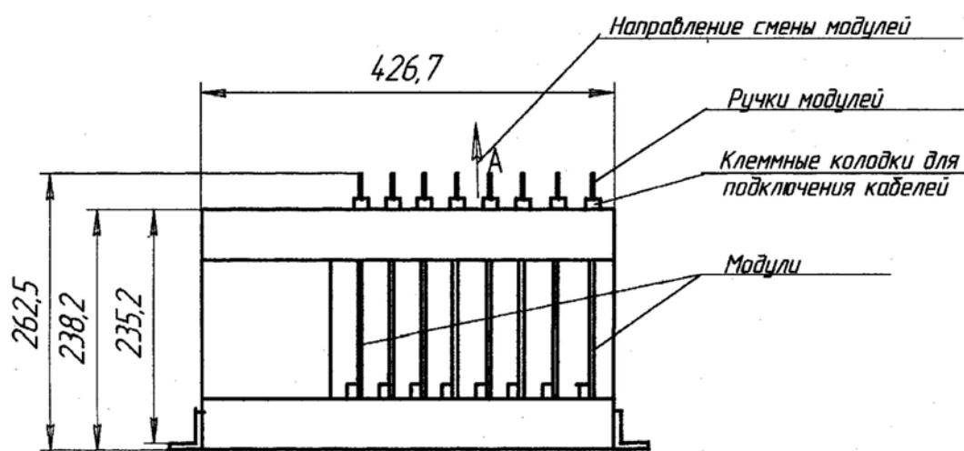
*Устройство пороговое УПЭС выполнено в виде стандартного блока типа ЗУ19", предназначенного для установки в стойку.*
