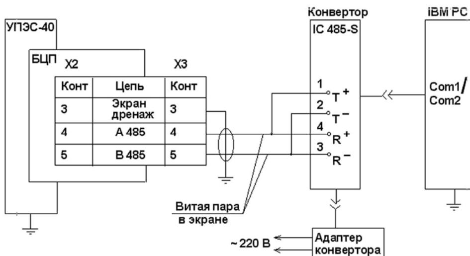
Рис. B.2 Схема электрическая связи УПЭС-40 с компьютером по стандарту RS 485
