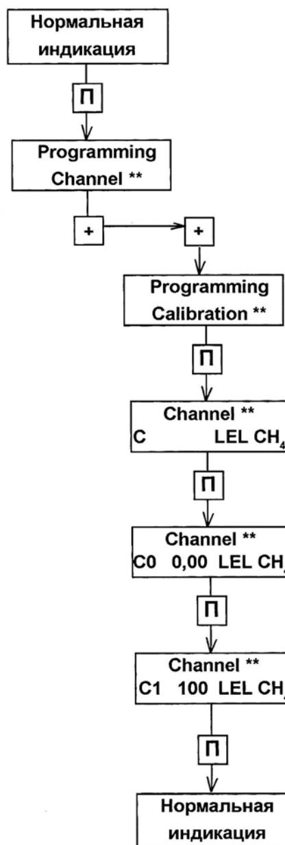
Кнопками **[+]** и **[−]** добиться получения показаний на индикаторе 0.0 LEL при подаче на вход канала тока  $(4,0 \pm 0,01)\text{mA}$
