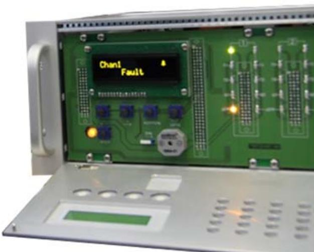
Рис. 3.4. Индикация УПЭС при потере связи с ИПЭС. Сопровождается звуковым сигналом.
