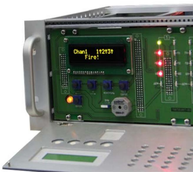
Рис. 3.2 Неисправность ИПЭС (запыленность), отображение индикации неисправности на УПЭС. Сопровождается звуковой сигнализацией
