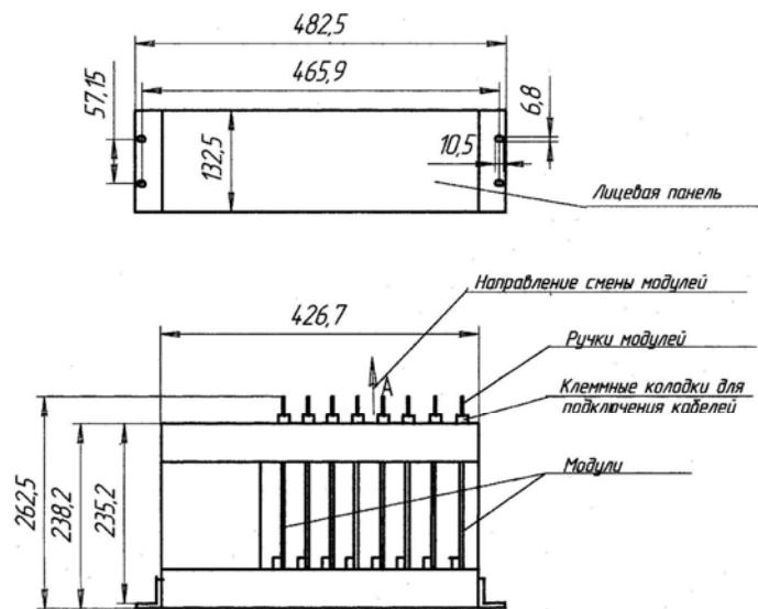
Панель управления УПЭС выполнена в виде стандартного блока типа 3U19", предназначенного для установки в стойку.
