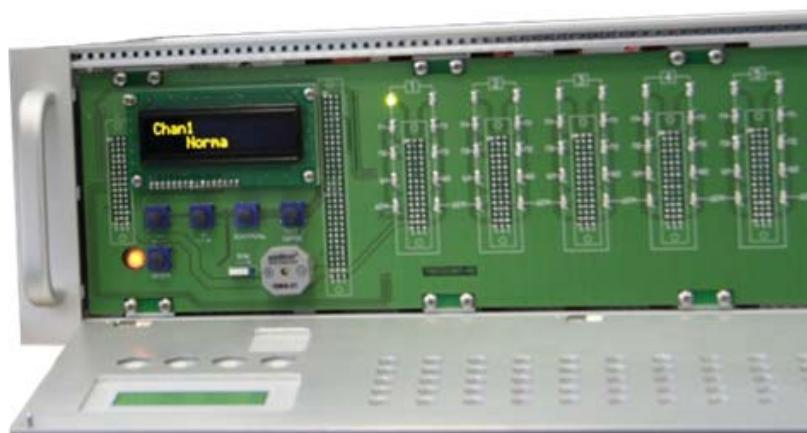
Рис. 3.1. Индикация пожара, сопровождаемая звуковой сигнализацией.
