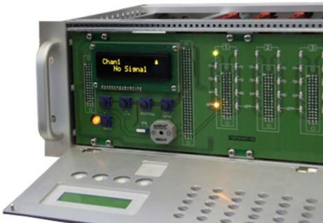
Рис. 4.2. Индикация «Неисправность». Сопровождается звуковой сигнализацией
