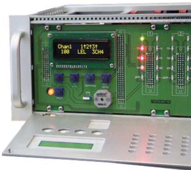
Рис. 4.5 Индикация «Превышение». Сопровождается звуковой сигнализацией
