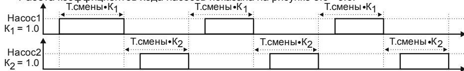
Рисунок 3.5 - Работа насосов при одинаковых коэффициентах хода
