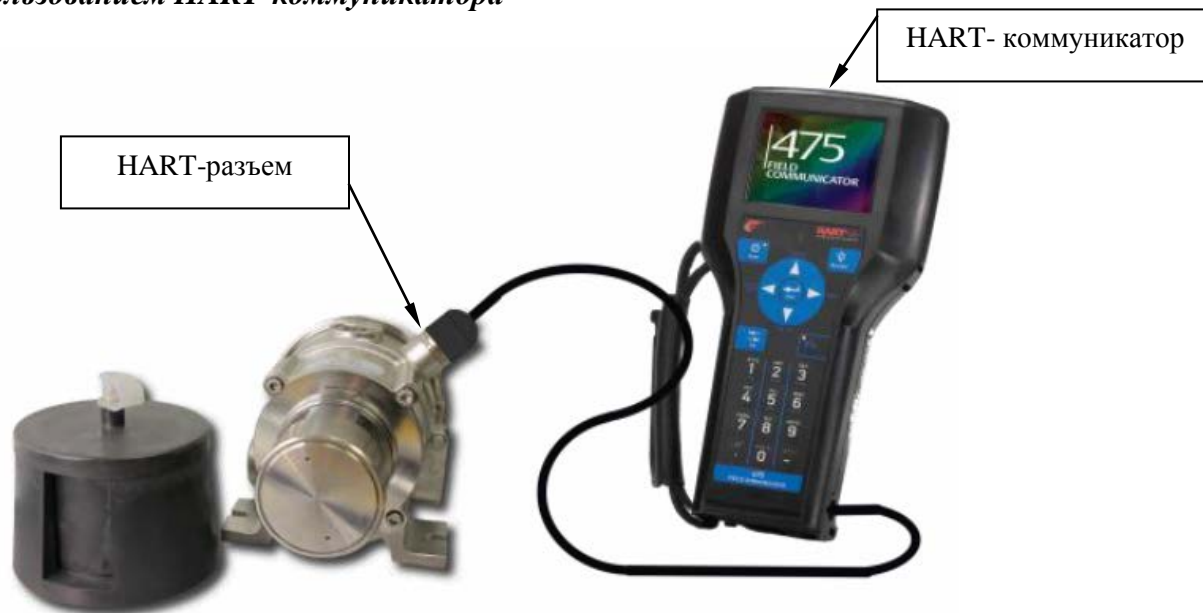
Рисунок 13 – Газоанализатор СГОЭС-М11, подключенный к HART-коммуникатору
